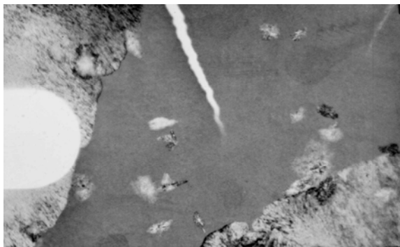
Р и с. 7. Микрофотография структуры образца Тс+25% С. Зигзагообразное продвижение микротрещины по аморфной части образца. \times 100\,000
