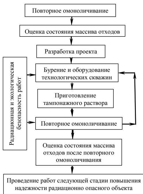
Р и с. 4. Технологические операции повторного омоноличивания массива отходов
