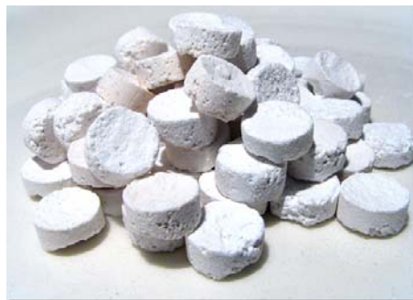
Р и с. 1. Сорбционные таблетки на основе гидрофторида бария
