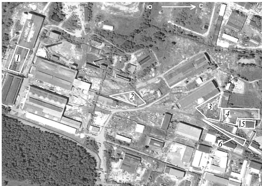
Р и с. 1. Расположение основных загрязненных объектов Подольского завода цветных металлов: 1 — рафинировочное отделение; 2 — шлакоотвалы № 6, 7; 3 — площадка загрязненного металлолома; 4 — шлакоотвалы № 1—5; 5 — склад отдела капитального строительства; 6 — железнодорожное полотно
