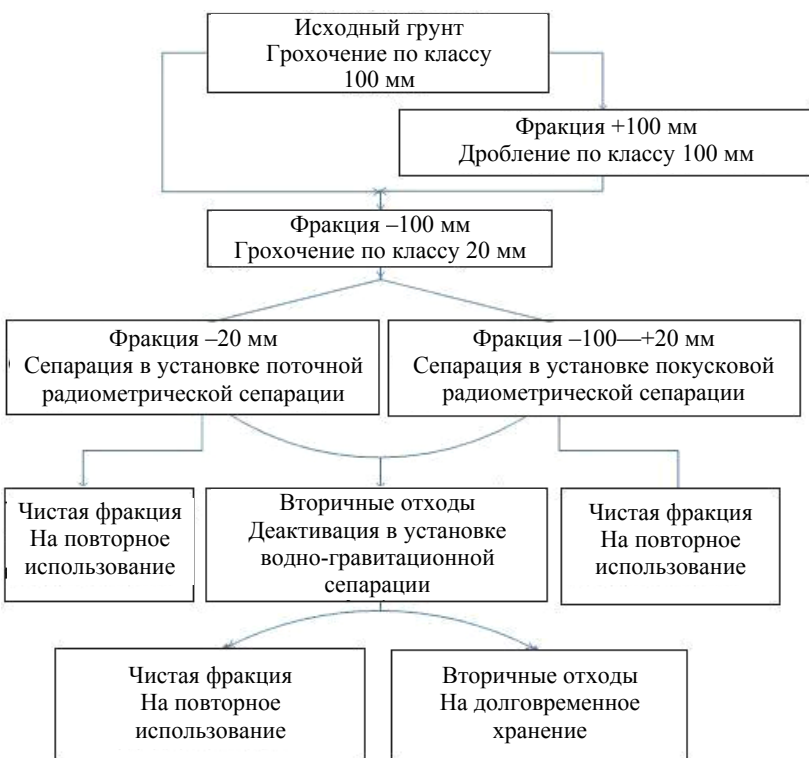
Р и с. 4. Укрупненная технологическая схема переработки радиоактивно загрязненного грунта площадки Подольского завода цветных металлов
