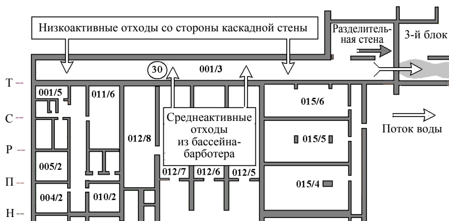
Р и с. 1. Скопления воды и водные потоки в северной части бассейна-барботера (1-й этаж)
