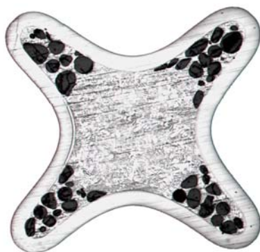
Р и с. 2. Поперечное сечение твэла с вытеснителем
