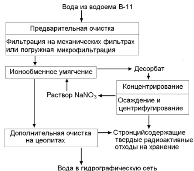
Р и с. 1. Принципиальная технологическая схема очистки теченского каскада водоемов от радионуклидов
