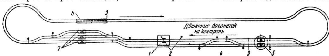
Рис. 5. Технологическая схема автоматической кольцевой сортировочной горки.
