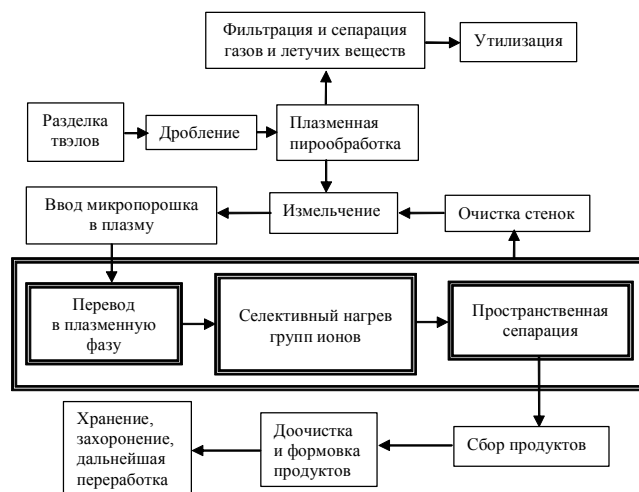
Р и с. 3. Схема технологического процесса переработки отработавшего топлива
