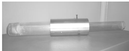
Р и с. 3. Двойной кварцевый тигель, зафиксированный в запердельном волноводе
