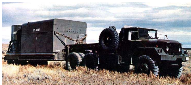
Р и с. 4. Реакторный блок транспортабельной ЯЭУ ML-1 (США) на прицепе армейского тягача
