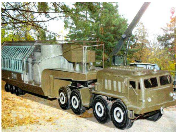
Р и с. 1. Транспортабельная атомная станция с газотурбинным циклом «Памир-630Д» — реакторный энергоблок в процессе установки в позиционное положение
