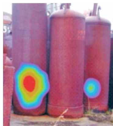
Рис. 8. Изображение контейнеров на открытой площадке, полученное с помощью гамма-визора
