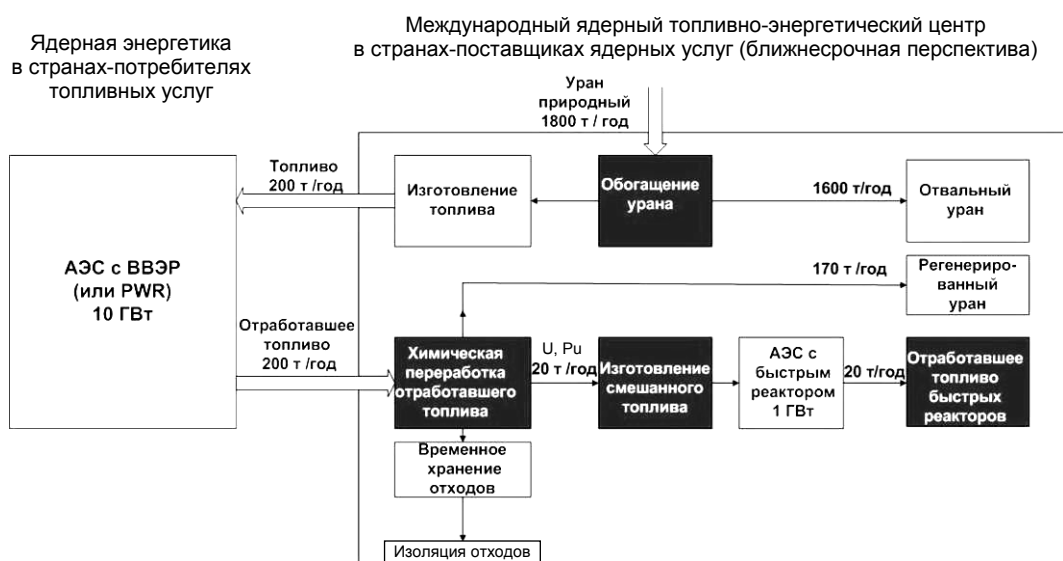
Р и с. 2. Принципиальная структура и балансовые потоки в системе с международным ЯТЭЦ по предоставлению услуг ядерного топливного цикла
