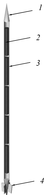
Р и с. 1. Твэл: 1 — верхний обтекатель; 2 — топливный компакт; 3 — оболочка; 4 — элемент вертикального дистанционирования
