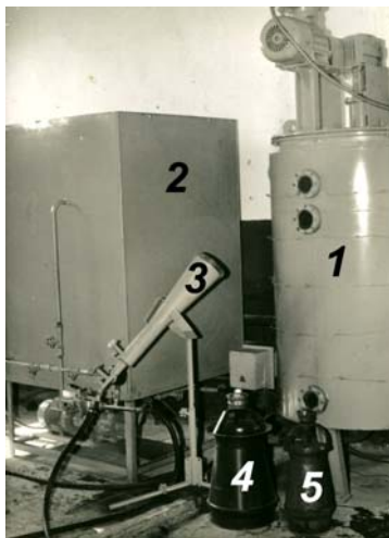
Р и с. 2. Опытная стендовая установка для получения пены средней и высокой кратности: 1, 2 — узел приготовления и подачи раствора соответственно; 3—5 — генератор пены высокой кратности ГП-3, средней кратности ГПС-600 и ГПС-200 соответственно
