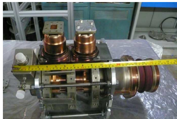
Р и с. 2. Компактный многолучевой клистрон
