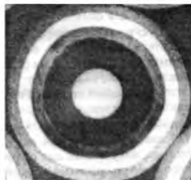
Р и с. 4. Микроструктура микротвзла в экваториальном сечении ( \times 100 )
