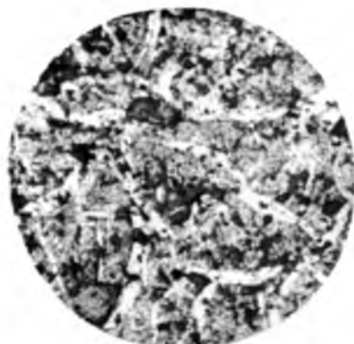
Р и с. 2. Микроструктура кернов PuO_{2-x} ( \times 280 )
