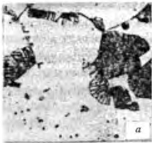
Р и с. 4. Микроструктура метастабильной \gamma^t -фазы сплава урана с атомной долей молибдена 13,6%, образовавшейся при закалке из \gamma -области ( \times 320 )
