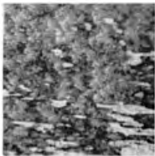
Р и с. 2. Смесь кусков конструкционных материалов ТВС и осадка в трубопроводе импульсного пневматического транспортирования перед началом процесса
