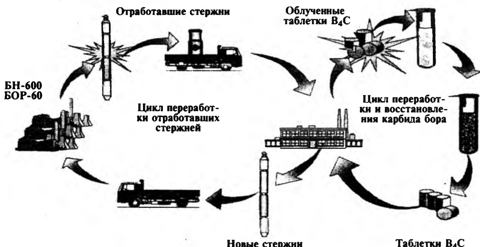
Р и с. 14. Замкнутый цикл использования обогащенного карбида бора в стержнях аварийной защиты БН-600 и BOR-60
