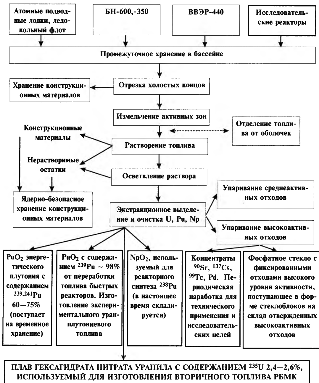
Р и с. 1. Переработка отработавшего топлива на РТ-1
