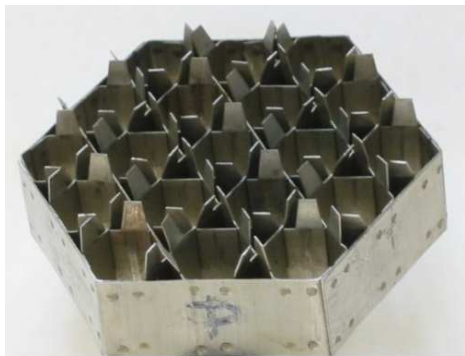
Р и с. 4. Модернизированная перемешивающая решетка [16]
