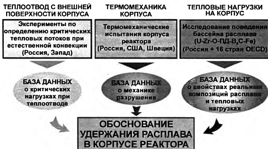
Р и с. 4. Экспериментальные программы по исследованию процессов в бассейне расплава активной зоны на днище корпуса реактора
