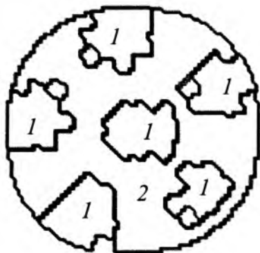
Р и с. 3. Решение оптимизационной задачи (11) для варианта 3 с удалением периферийных датчиков от центра на 0,7 радиуса активной зоны: 1 — области вокруг датчиков с \delta K_{\infty} = -0,01 ; 2 — область с \delta K_{\infty} = 0,01
