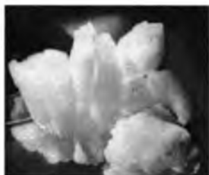
Р и с. 8. Внешний вид и микроструктура образцов аэрогеля оксида алюминия
