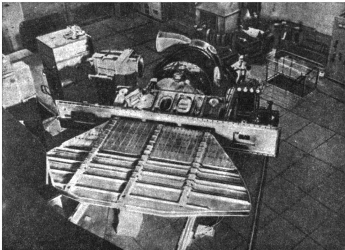
Рис. 2. Дуант, вынутый из вакуумной камеры.
