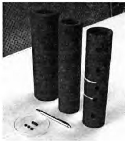
Р и с. 1. Образцы отработавших графитовых втулок
