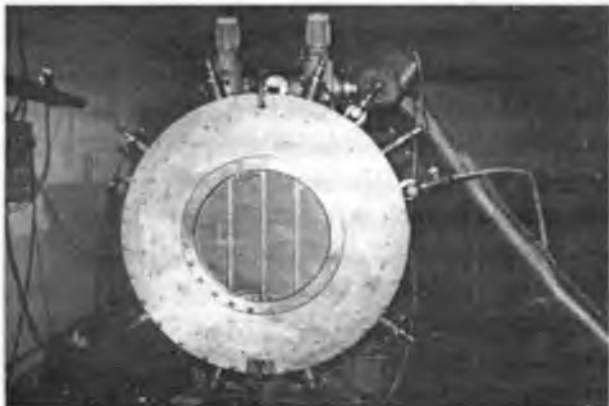
Р и с. 3. Устройство ионизации генератора озона со стороны устройства вывода пучка
