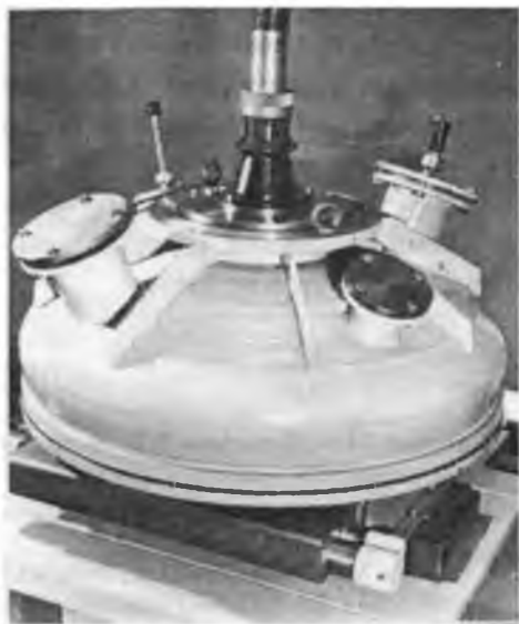
Р и с. 2. Малогабаритный широкоапертурный ускоритель ионов на основе высоковольтного тлеющего разряда — устройство ионизации СО-лазера
