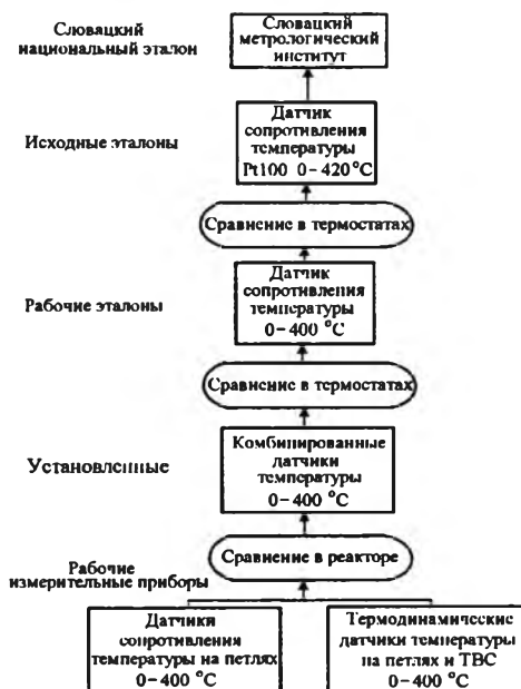
Р и с. 9. Метрологическая схема измерения температуры для ВВЭР-440
