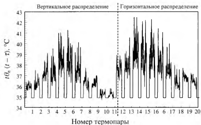
Р и с. 5. Температура теплоносителя на расстоянии от мембраны 300 мм
