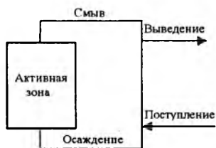
Р и с. 1. Схема к расчету активации нуклидов в активной зоне
