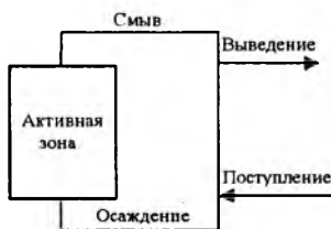
Р и с. 1. Схема к расчету активации нуклидов в активной зоне
