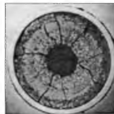
Рис. 2. Микро- и макроструктура поперечного сечения твэла БОР-60 выгоранием 32% тяж. ат.
