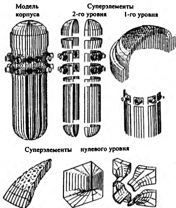
Р и с. 3. Конечно- и суперэлементное представление модели корпуса реактора
