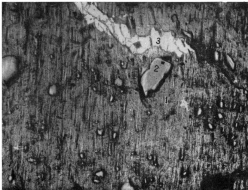
Рис. 1. Коффинит (1) с вкраплениями зерен кварца (2) и прожилки галенита (3). Полированный шлиф образца, взятого с глубины 33 м ( \times 110 ).
