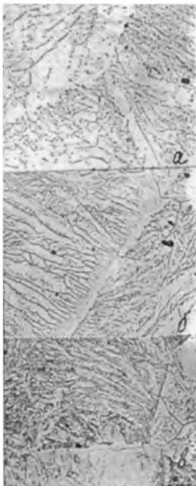
Р и с. 3. Сетчатая субструктура \beta -зерен в высокочистом уране после охлаждения из \gamma -области со скоростью 2,5 (а), 50 (б), 800 °C/с (в)
