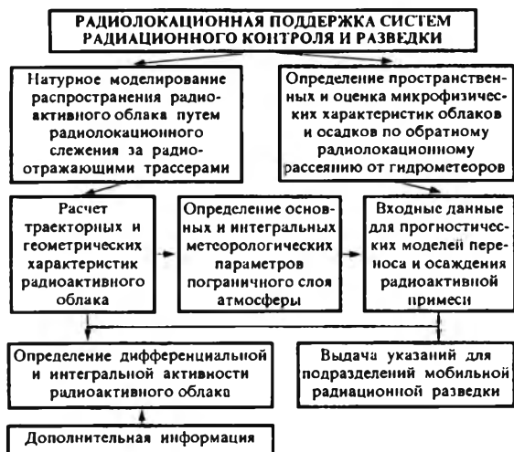
Р и с. 2. Радиолокационная поддержка системы радиационного контроля и разведки в районе радиационно опасного объекта
