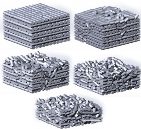
Р и с. 1. Трансформация укладки таблеток в процессе спекания
