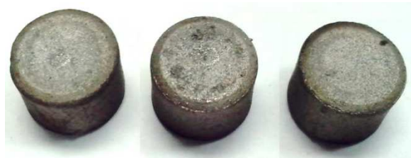
Р и с. 1. Внешний вид исследованных уран-молибденовых таблеток
