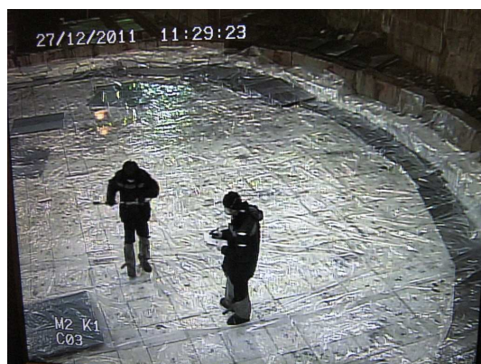
Р и с. 8. Измерения мощности дозы над поверхностью емкости хранения после установки экрана радиационной защиты (27.12.2011)
