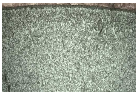
Р и с. 1. Микроструктура стали ЭП823 после коррозионных испытаний в свинце-висмутовой эвтектике длительностью 50 135 ч при T = 600 °С, C_{[O]} = (1—4)10^{-6}\% по массе
