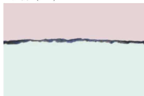
Р и с. 3. Микроструктура стали ЭП823 после коррозионных испытаний в свинце длительностью 16 672 ч при T = 650 °С, C_{[O]} = (1—4)10^{-6}\% по массе
