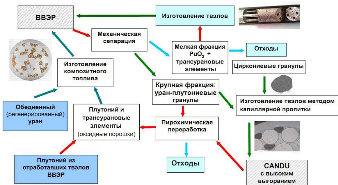
Р и с. 5. Топливный цикл легководяных реакторов на базе композитного топлива с многократным использованием переработанного плутония
