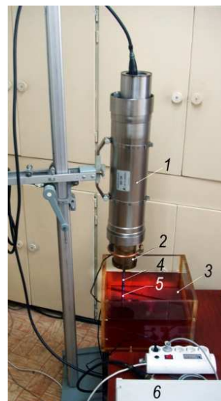
Р и с. 6. Испытания генератора нейтронов НГ-20: 1 — излучатель нейтронов; 2 — трубка ГНТ1-МД; 3 — трансформаторное масло; 4 — аппликатор; 5 — мишень; 6 — блок питания
