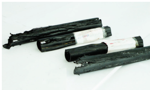
Р и с. 5. Образцы полиэтиленовых трубок после натяжения арматурного пучка (в местах перекрещивания пучков)
