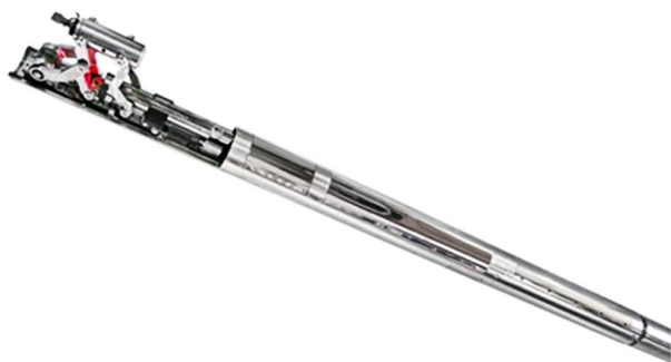
Р и с. 9. Устройство для фрагментации и удаления графитового блока
