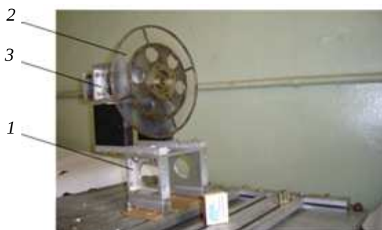
Р и с. 3. Полиэтиленовый конвертор: 1 — основание; 2 — вращающийся диск с пленкой из полиэтилена толщиной 150 мкм; 3 — электропривод
