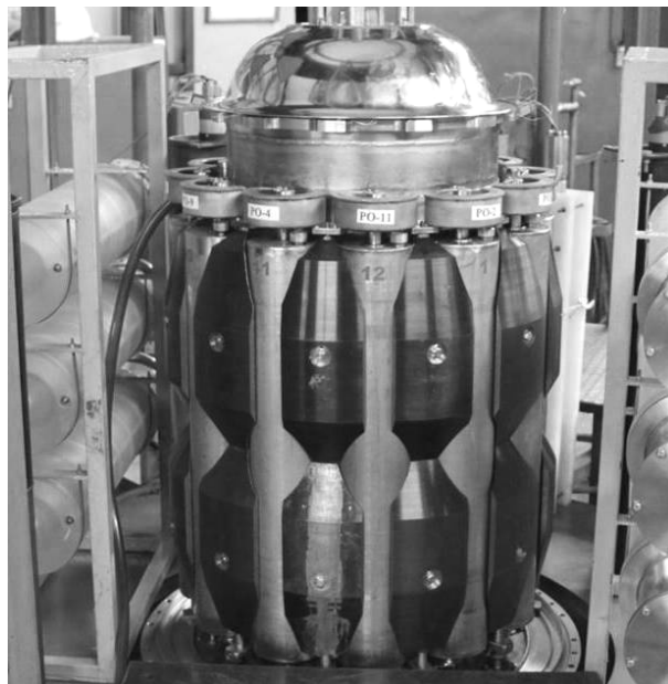
Р и с. 3. Критическая сборка-прототип термоэмиссионного реактора-преобразователя РП-50
