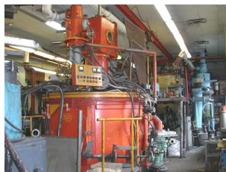
Р и с. 1. Установка центробежного распыления: 1 — питатель; 2 — электрод; 3 — вакуумная камера; 4 — вращающийся водоохлаждаемый тигель; 5 — электродвигатель; 6 — бункер-накопитель
